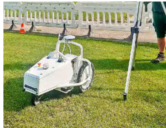
Markierroboter für GPS-gesteuerte Linierung
